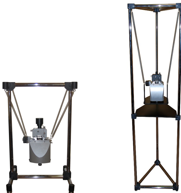
Рис. 3.1. Примеры настольной (слева) и напольной (справа) конструкций антивибрационной пружинной подвески блока сканирования АСМ.
