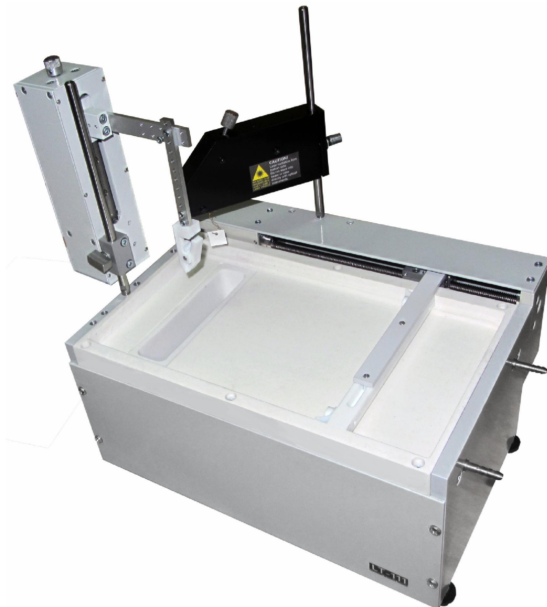
Рис. 1.6 – Ванна с установленными датчиком поверхностного давления и механизмом погружения/подъема.
