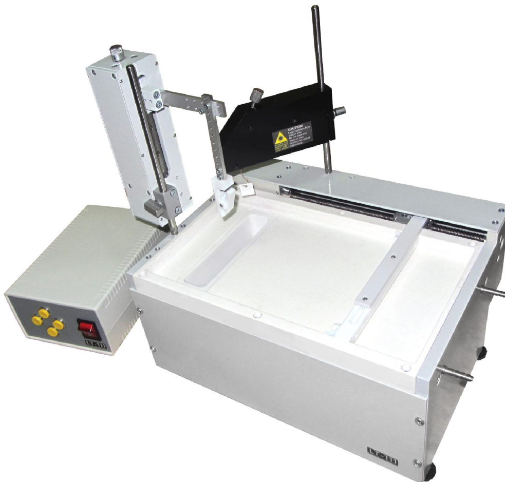
Рис. 1.1. Общий вид установки для нанесения моно- и мультимолекулярных пленок методом Ленгмюра–Блоджетт: Л-Б ванна (слева) и блок электроники (справа).
