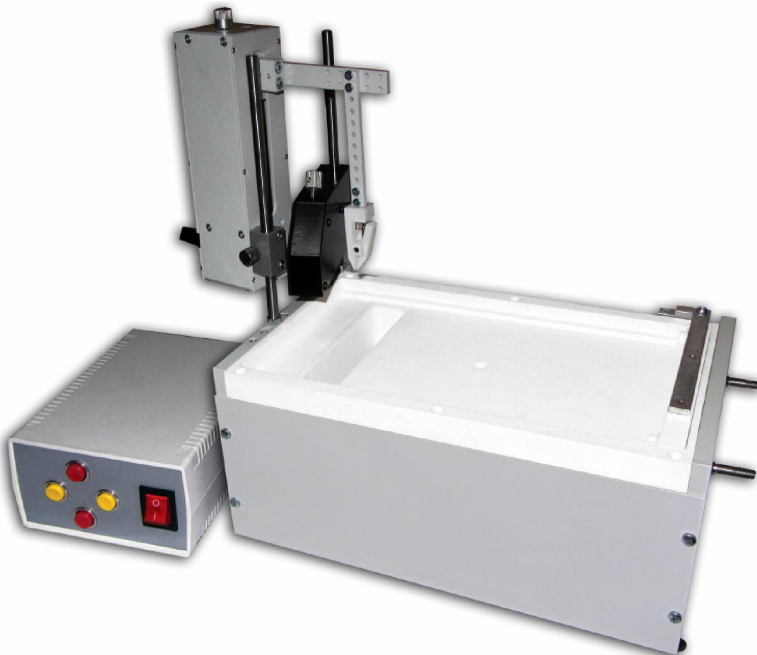
Рис. 1.1. Общий вид установки для нанесения моно- и мультимолекулярных пленок методом Ленгмюра–Блоджетт: Л-Б ванна (слева) и блок электроники (справа).
