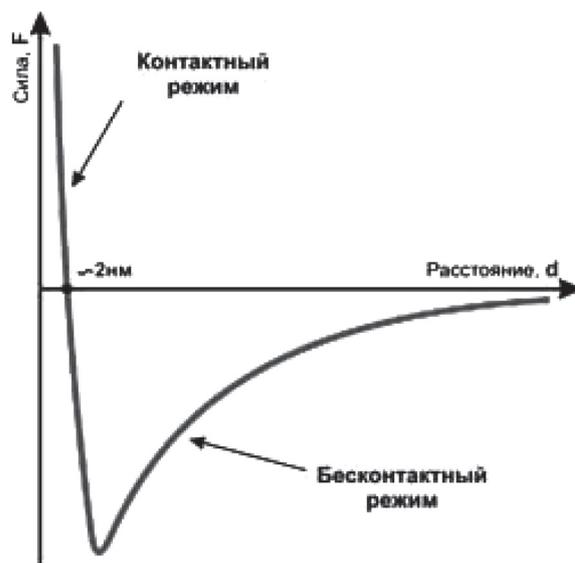
Рис. 1. Зависимость силы межатомного взаимодействия от расстояния между острием и образцом
