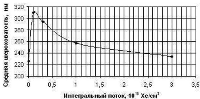
Рис. 5. Зависимость средней шероховатости поверхности графита от интегрального потока ионов Хе +
